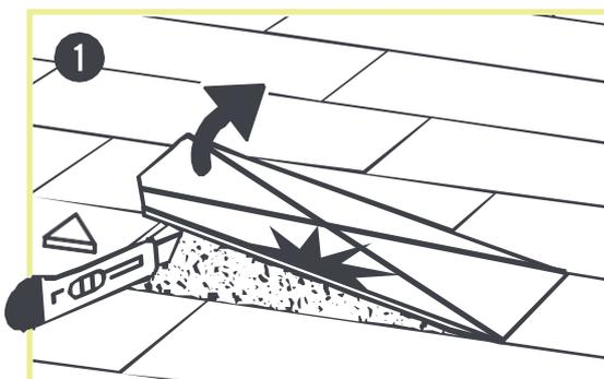
Corte el tablón en diagonal utilizando una cuchilla recta seguida de una cuchilla de gancho.
