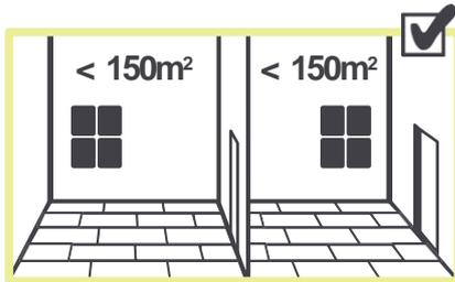
*La superficie de instalación no debe ser superior a 150 m<sup>2</sup>.*
