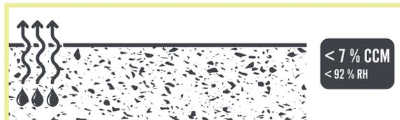
El contenido de humedad no debe superar el 7% con una prueba de humedad de carburo.
