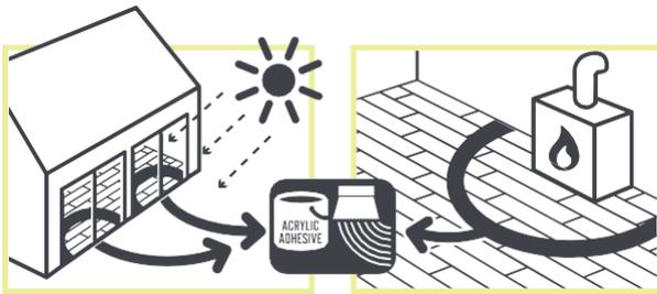
*Frente a un mirador, una chimenea y cualquier otra fuente de calor excesivo, las planchas /tejas deben pegarse a más de 50 cm a 1 m.*
