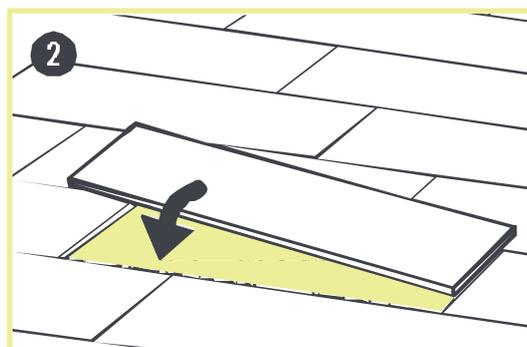
Aplique cinta adhesiva de doble cara debajo de la plancha. Vuelva a colocar la nueva plancha / baldosa.
